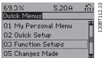
Ilustracja 5.4: Krok 3: Za pomocą przycisków nawigacji góra/dół przeglądać zestawy parametrów funkcji. Nacisnąć przycisk [OK].
