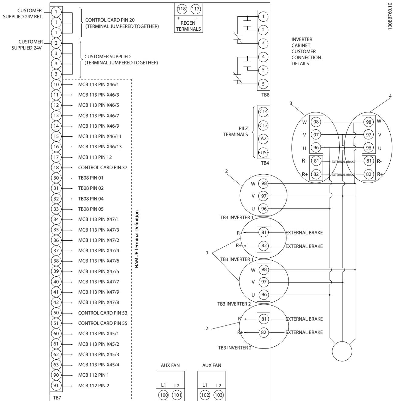
圖 4.10 顯示所有不含選項的電氣端子的圖表。
