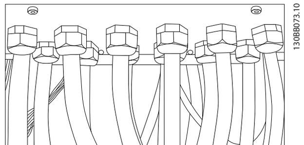
圖 3.17 纜線固定頭板正確安裝的範例。
