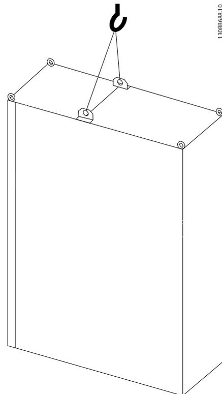
圖 3.2 建議的吊掛方式，機架大小 F9/F10。
