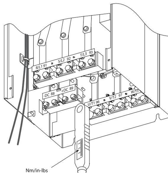
圖 4.8 務必使用扭力扳手將螺栓扭緊。
