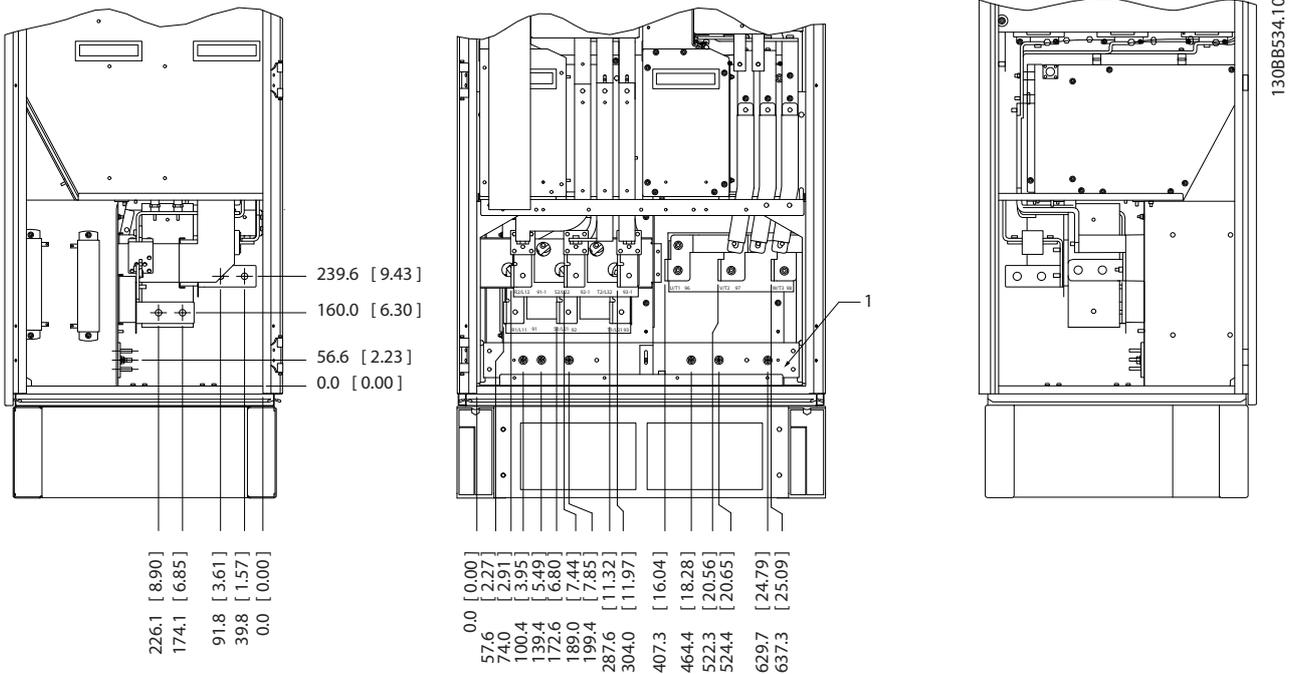
圖 3.10 端子位置 - 逆變器與整流器機櫃 - F8 與 F9 (正視圖、左視圖與右視圖)。 纜線固定頭板是 42mm, 低於 .0 的等級。
