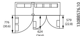
圖 3.8 IP21/IP54 外殼類型, 機架大小 F12 的前方空間
