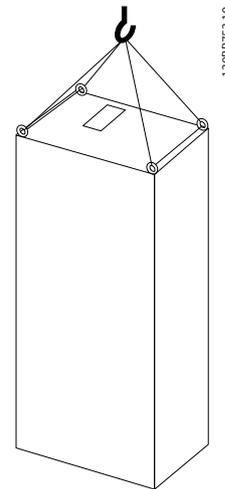
圖 3.1 建議的吊掛方式，機架大小 F8。
