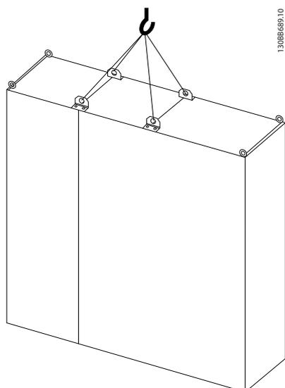
圖 3.3 建議的吊掛方式，機架大小 F11/F12/F13。
