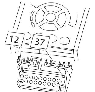
圖 2.1 端子 37 和 24 V 直流電源之間的橋接器跳線
