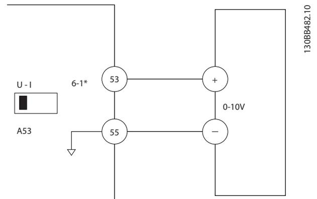
그림 5.10 0-10V 제어 신호를 제공하는 외부 장치를 위한 배선 예시
