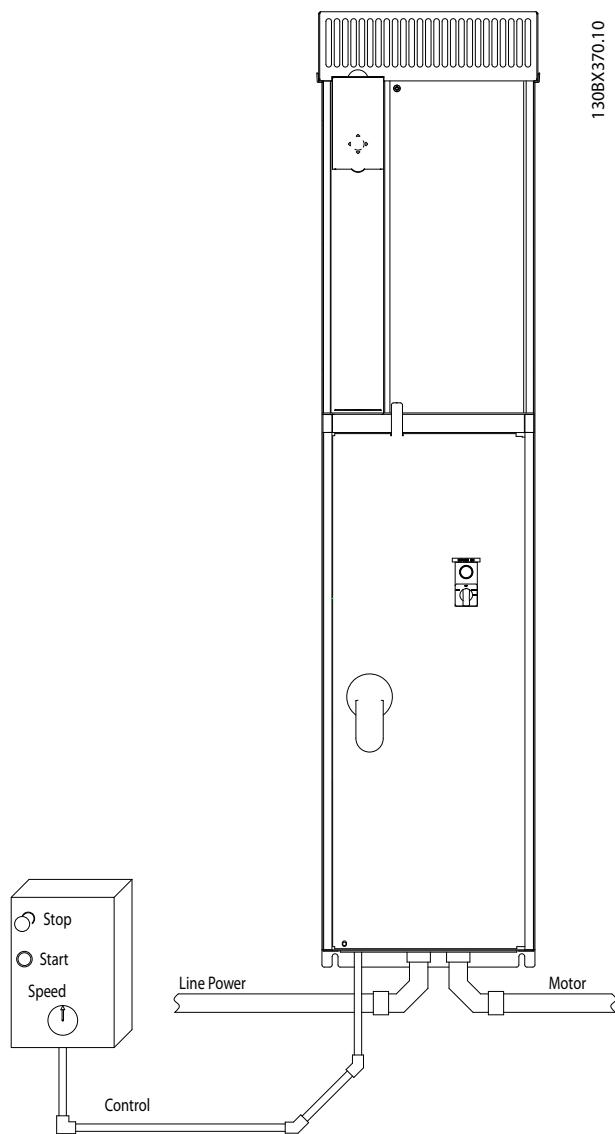
그림 2.3 도관을 사용한 올바른 전기적인 설치의 예
