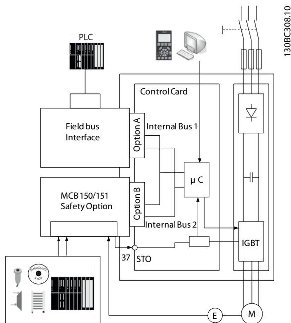
Disegno 3.1 FC 302 con opzione di sicurezza e opzione fieldbus
