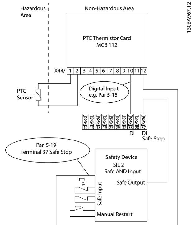
圖 3.3 結合 Safe Torque Off 應用和 MCB 112 應用
