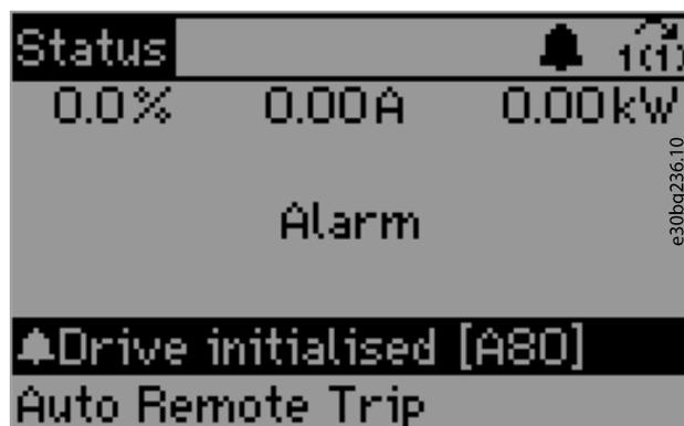
Abbildung 1.8 Alarm A80, Frequenzumrichter initialisiert
