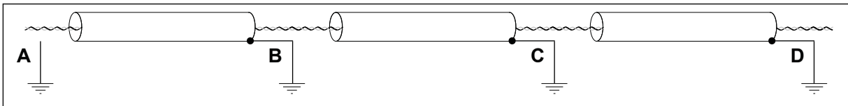
Bild 42: Jordning i störande miljö med dålig utjämningspotential. Ett exempel på hur skärmen kapas.
