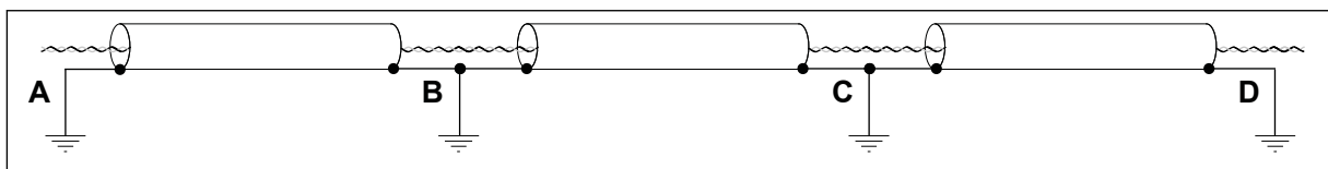
Bild 38: Jordning i störande miljö med bra utjämningspotential. Om potentialerna vid punkterna A, B, C och D är olika och inte kan göras likadana, ska skärmarna kapas som i Bild 39.
