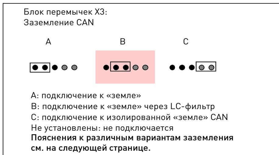
Рис. 26. Возможные положения перемычек X3 для платы OPT-D2 (начиная с версии H включительно)
