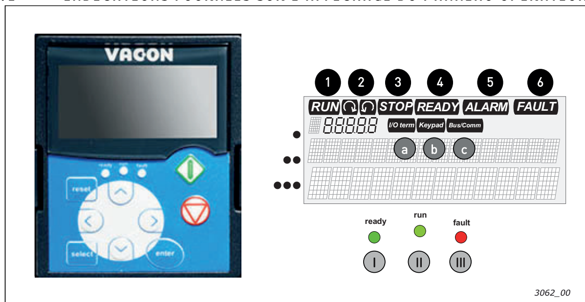
Figure 77. Panneau opérateur VACON® et indications d'état du variateur
