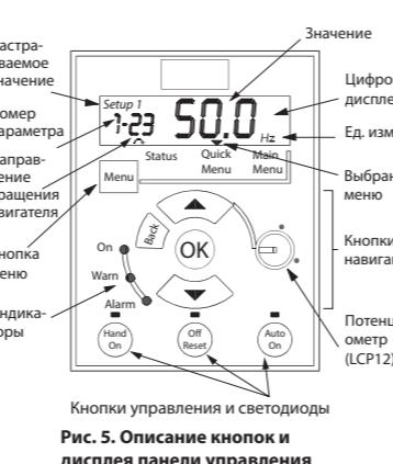
Рис. 5. Описание кнопок и дисплея панели управления
