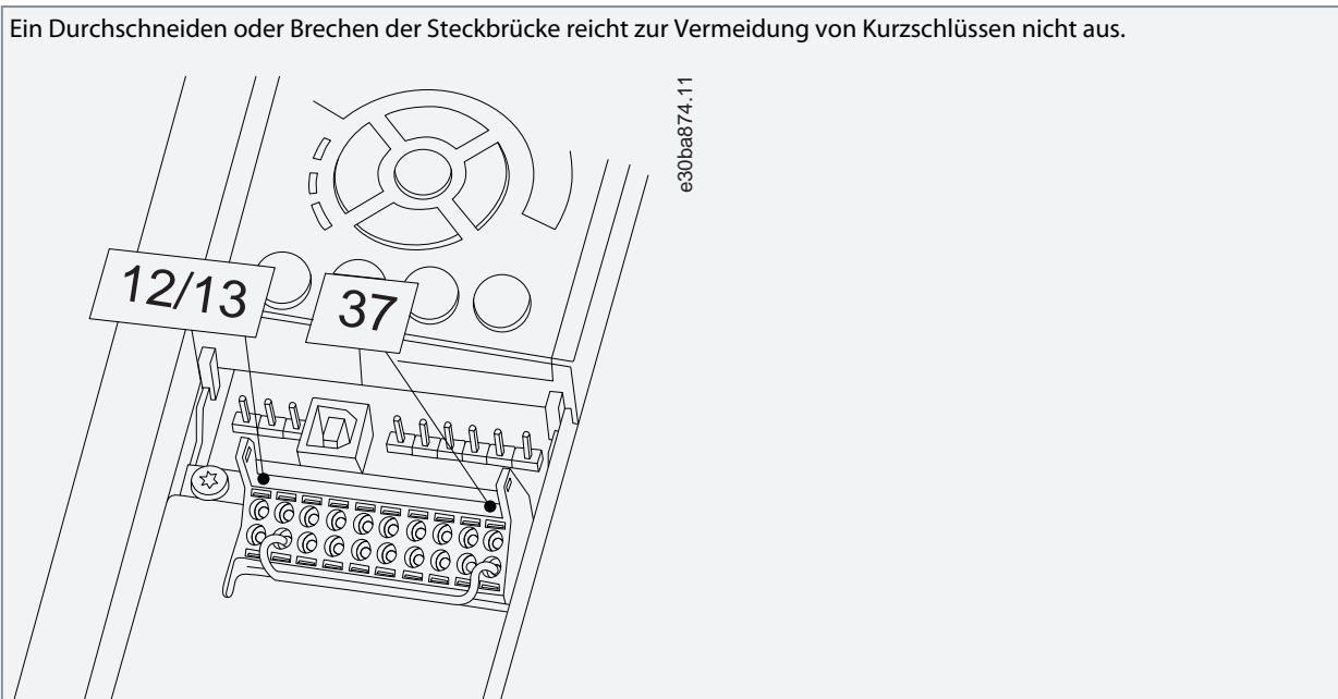
Abbildung 9: Steckbrücke zwischen den Klemmen 12/13 und 37 (VLT® AutomationDrive FC 302)
