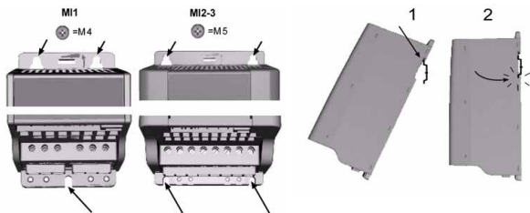
Figur 1: Skruer montering til venstre og DIN-skinne montering til høyre
