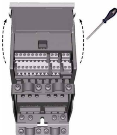
Abbildung 3.7: Öffnen der Abdeckung
