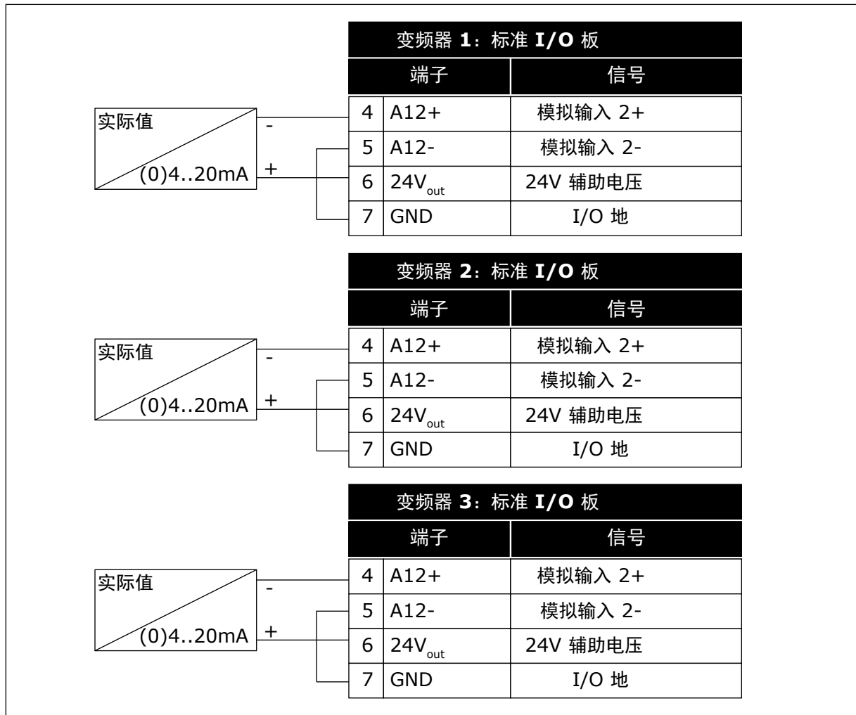
图 93: 每个变频器的反馈传感器的接线
