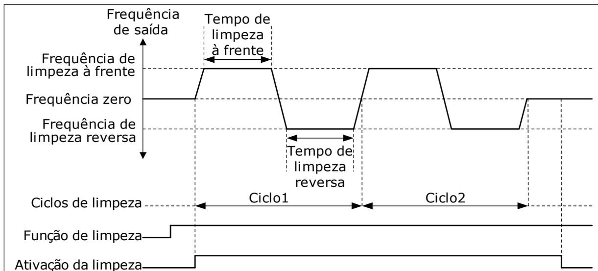
Fig. 104: A função Limpeza automática
