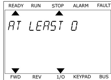
Após essas etapas, um sinal digital para a entrada digital DI6 controlará a função Fechar falha externa.
