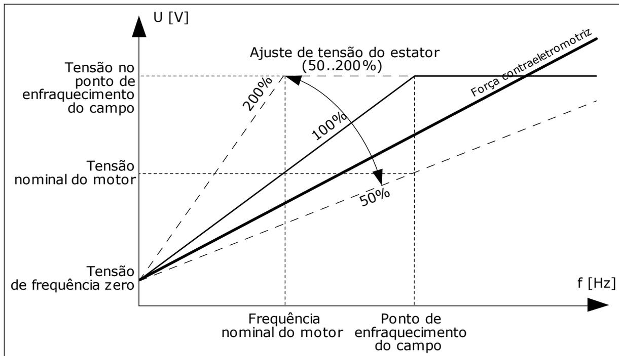
Fig. 37: O ajuste de tensão do estator
