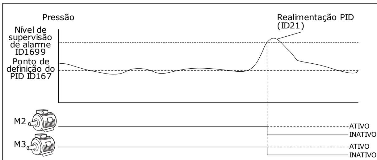
Fig. 100: A função de supervisão de sobrepressão
