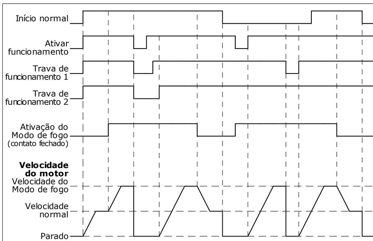
Fig. 103: A função do Modo de incêndio
