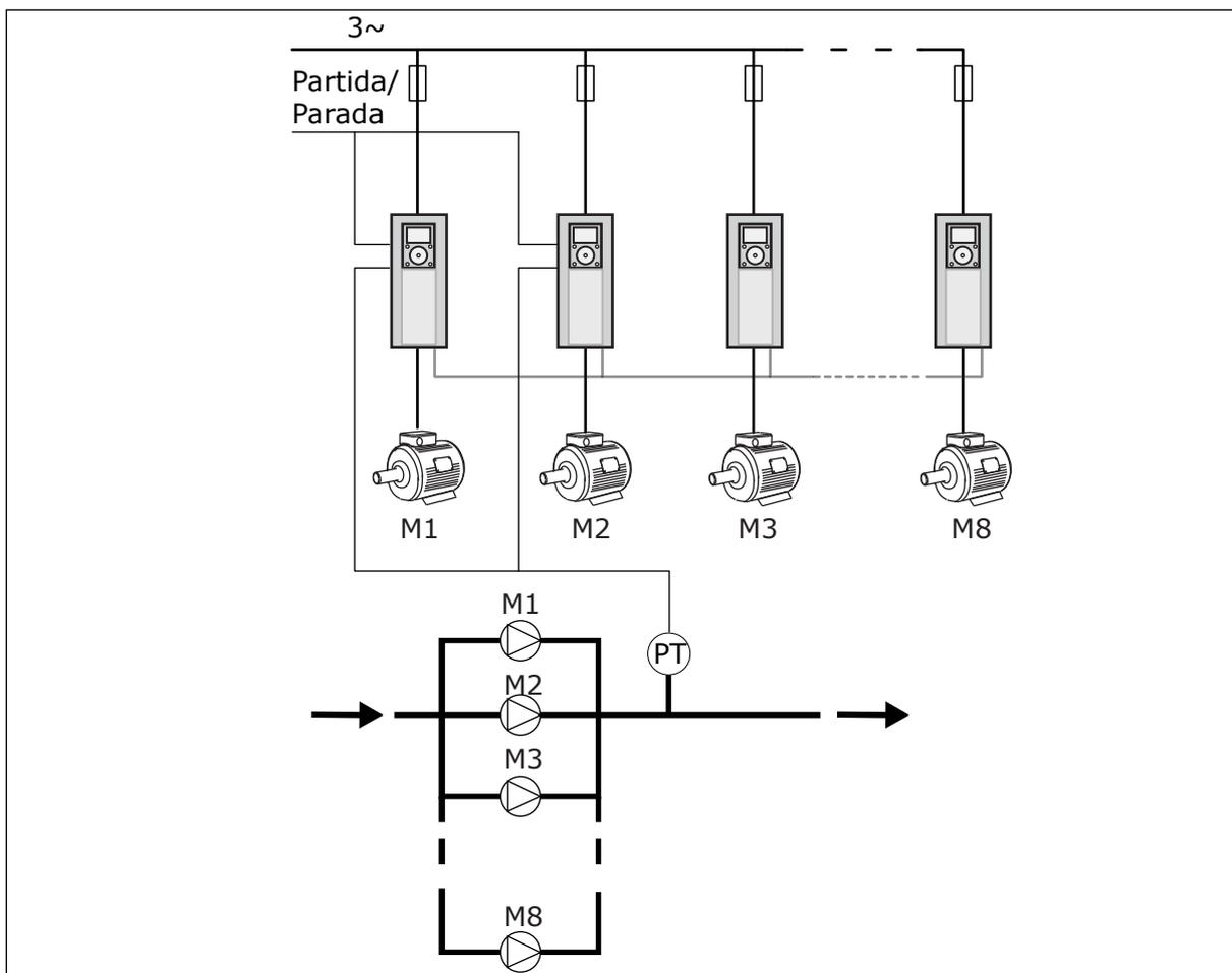
Fig. 90: Configuração de Multiconversor (PT = sensor de pressão)
