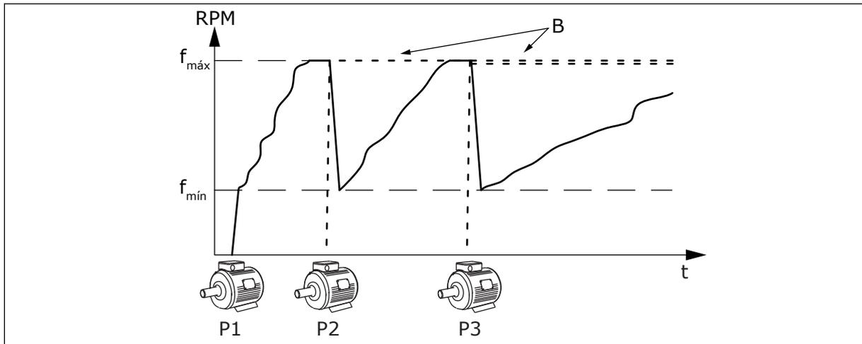
Fig. 91: Controle no modo de Conversor único
