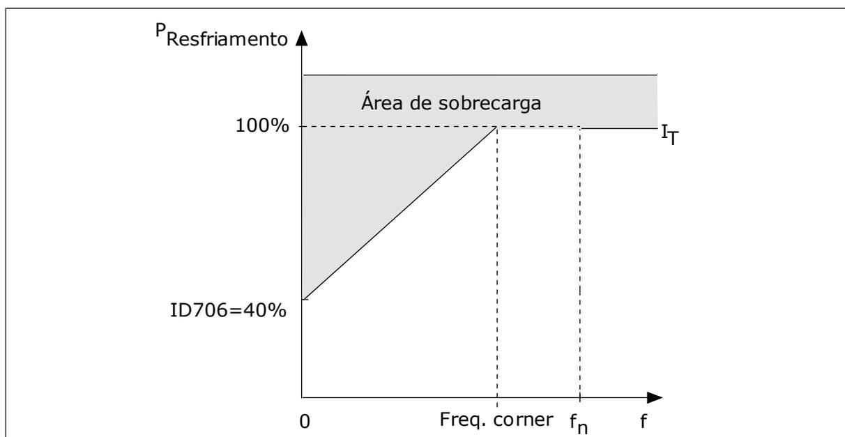
Fig. 65: Curva  $I_T$  da corrente térmica do motor
