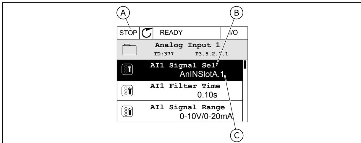
Fig. 54: O menu Entradas analógicas na exibição gráfica
