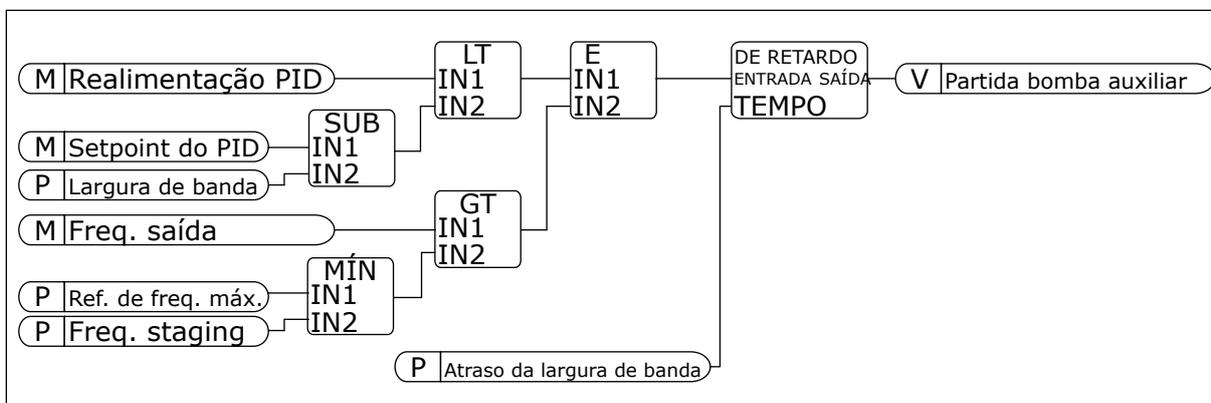
Fig. 101: Frequência de staging
