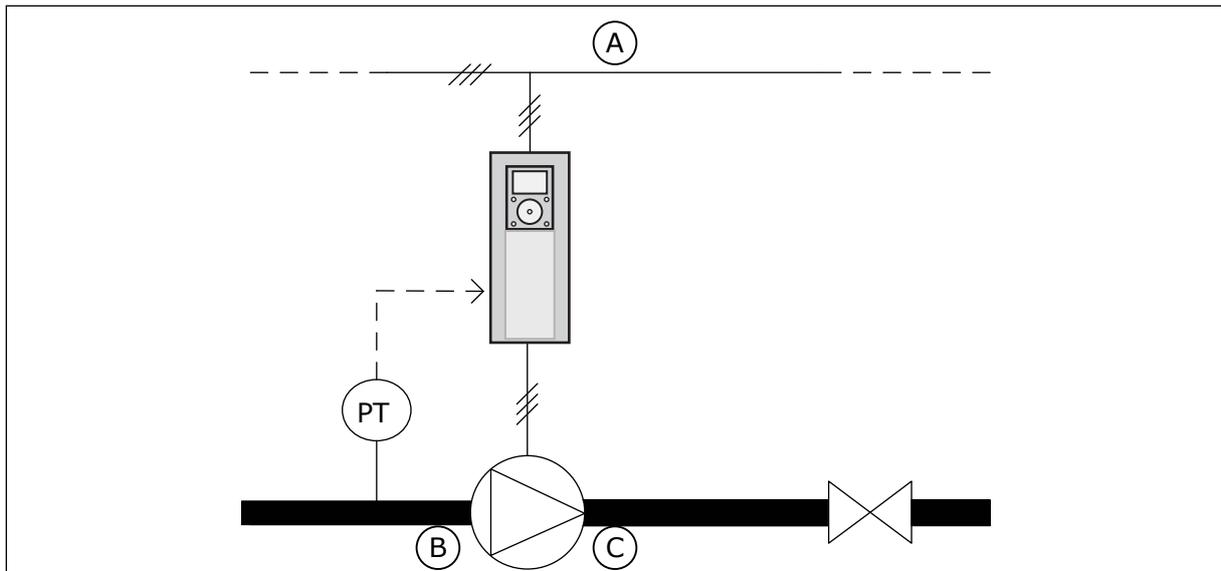
Fig. 86: A posição do sensor de pressão
