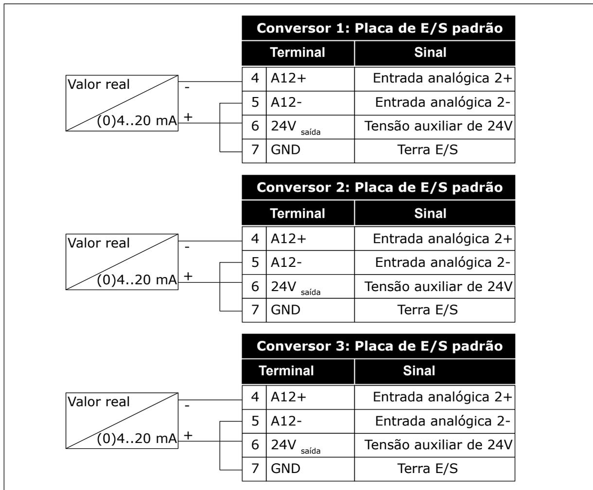
Fig. 94: Cabeamento dos sensores de realimentação para cada conversor
