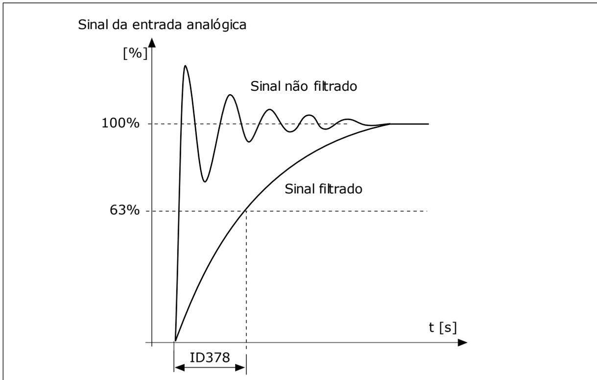
Fig. 56: A filtragem do sinal de AI1
