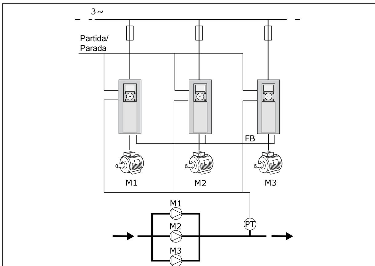
Fig. 13: Configuração Multibomba (multiconversor)
