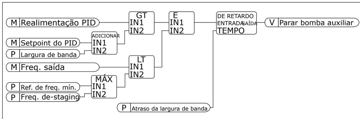
Fig. 102: Frequência de de-staging
