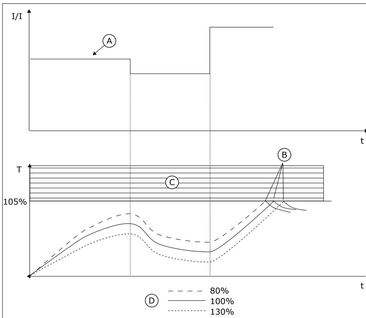
Fig. 67: O cálculo da temperatura do motor
