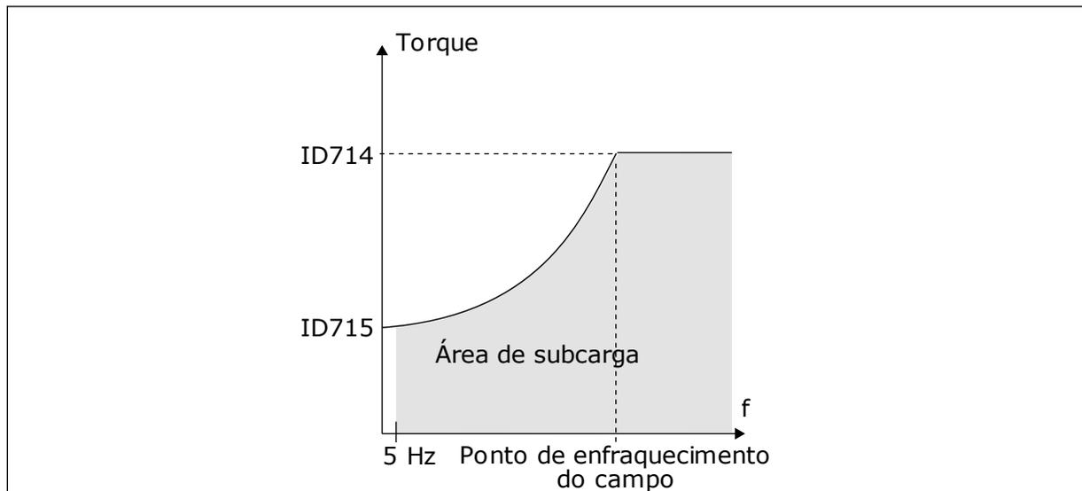
Fig. 69: Configuração da carga mínima
