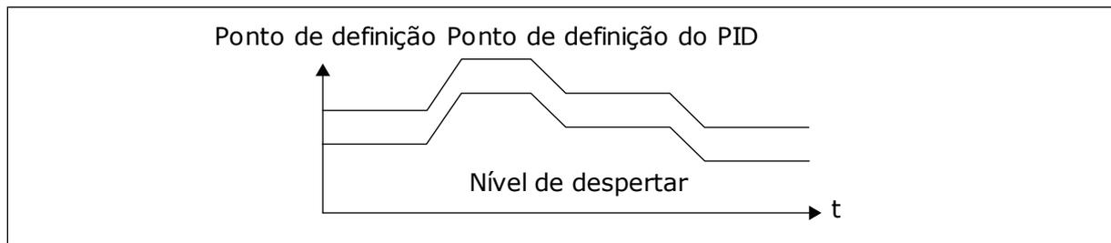
Fig. 82: Modo de despertar: ponto de definição relativo
