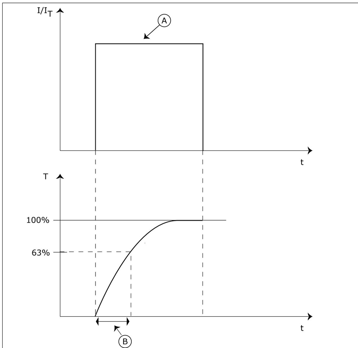
Fig. 66: A constante de tempo térmica do motor
