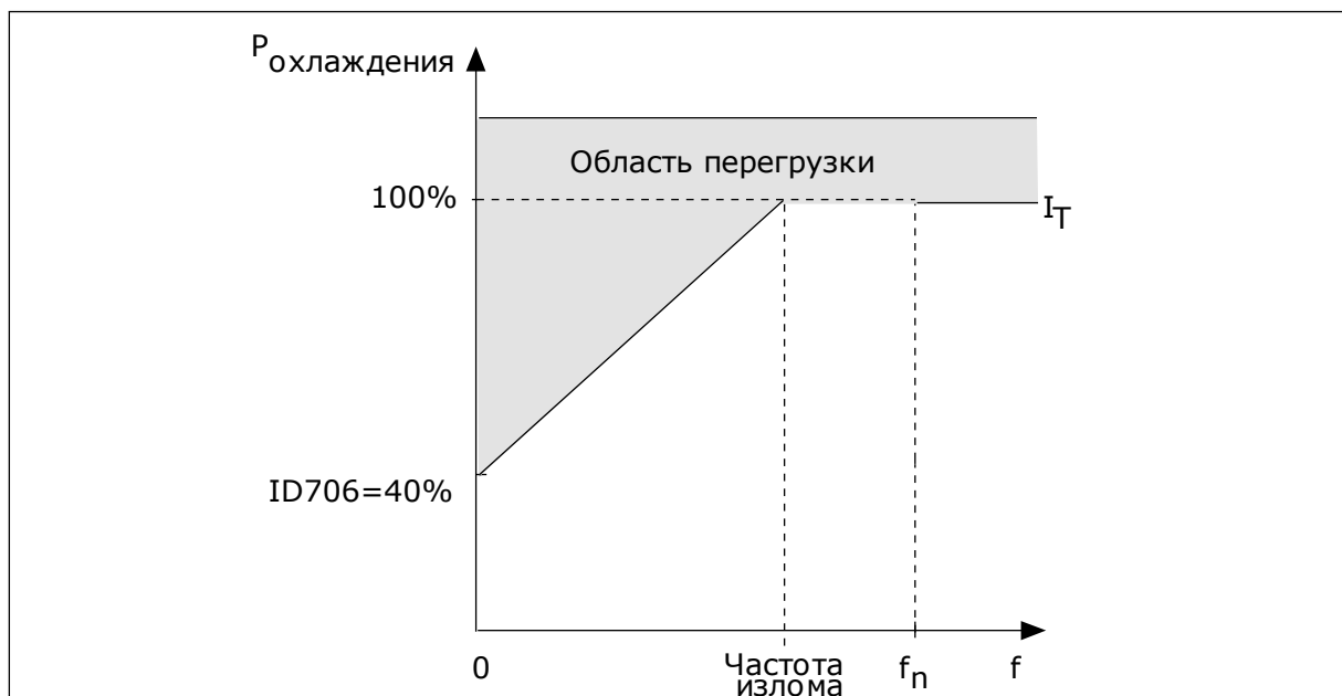
Рис. 24: Тепловой ток двигателя I_T кривая
