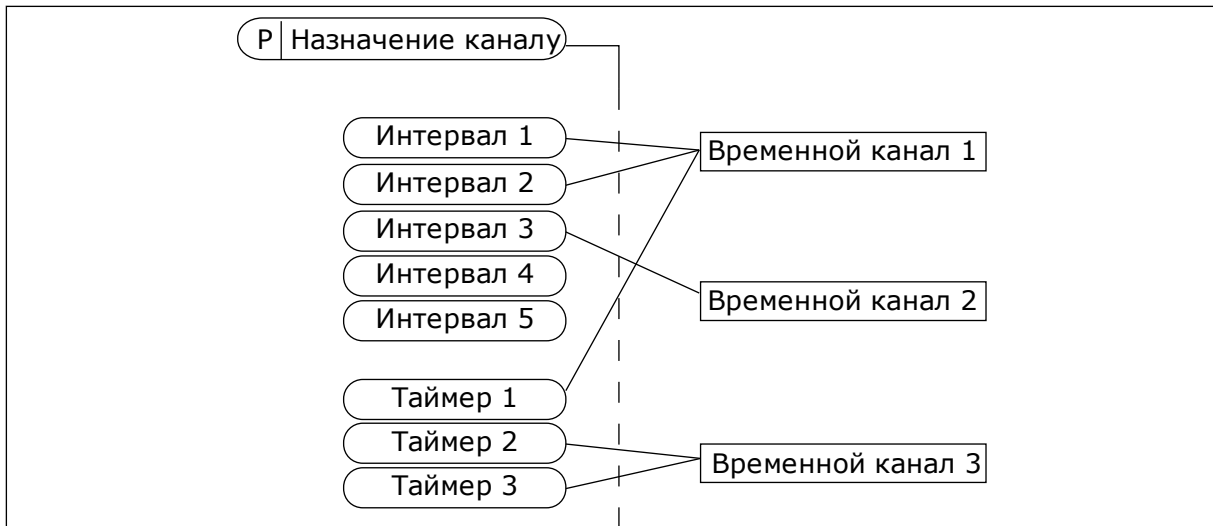
Рис. 64: Имеется возможность гибкого назначения интервалов и таймеров для временных каналов. Для каждого интервала и таймера предусмотрен собственный параметр для назначения временному каналу.
