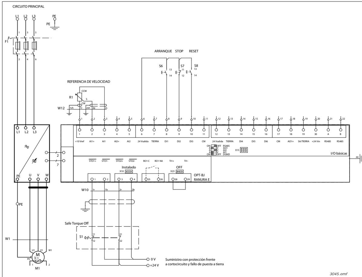
La figura anterior presenta un ejemplo de conexión de la tarjeta OPTBJ para la función de seguridad STO con reset. El interruptor S1 está conectado con 4 cables a la tarjeta OPTBJ como se muestra. La entrada digital 3 (DIN3), por ejemplo, está cableada para la función de reset de fallo. La función de reset (que no forma parte de ninguna función de seguridad) se puede programar para cualquiera de las entradas digitales disponibles.
