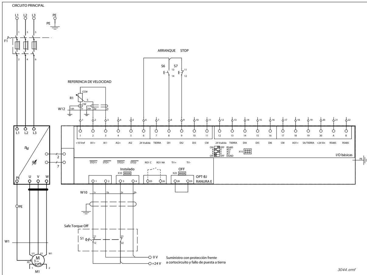
La figura anterior muestra un ejemplo de conexión de la tarjeta OPTBJ para la función de seguridad Safe Torque Off sin reset. El interruptor S1 está conectado con 4 cables a la tarjeta OPTBJ como se muestra.
