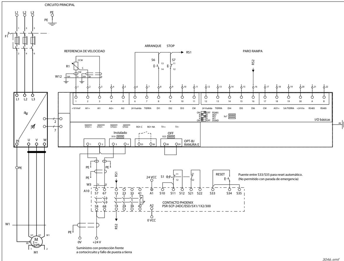
La figura anterior presenta un ejemplo de conexión de la tarjeta OPTBJ para la función de seguridad SS1 con módulo de relé de seguridad externo y con reset de seguridad.
