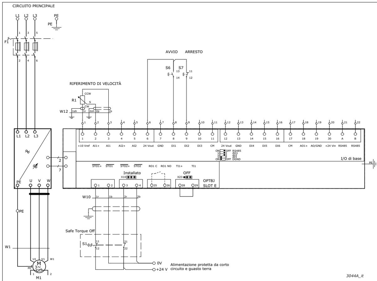
La figura sopra mostra un esempio di connessione della scheda OPTBJ per la funzione di sicurezza Safe Torque Off senza reset. L'interruttore S1 è collegato con 4 fili alla scheda OPTBJ, come illustrato sopra. L'interruttore S1 potrebbe essere alimentato dalla scheda di controllo (piedini 6 e 7 del connettore nella figura sopra) oppure potrebbe essere alimentato esternamente.
