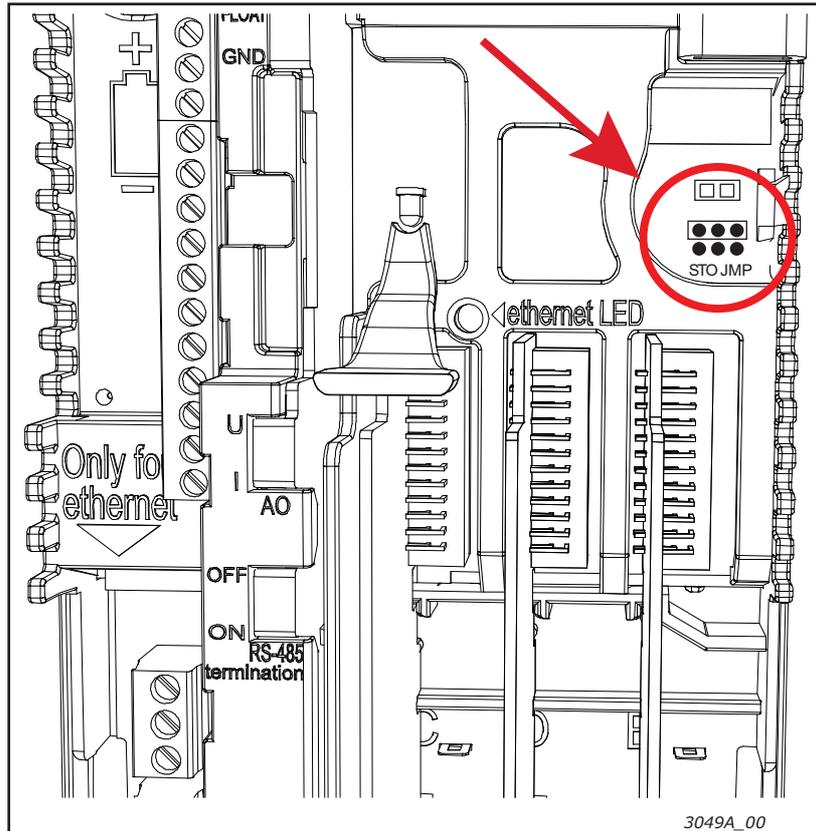
Figura 3. Posizione dei jumper STO sul Vacon 100. Aprire il coperchio principale e il coperchio interno per scoprire il jumper
