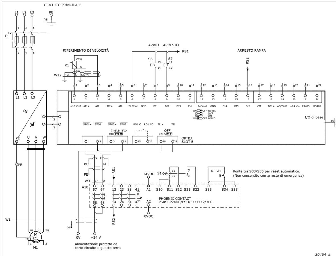
La figura sopra riportata presenta un esempio di collegamento della scheda OPTBJ per la funzione di sicurezza SS1 con modulo relè di sicurezza esterno e reset di sicurezza.
