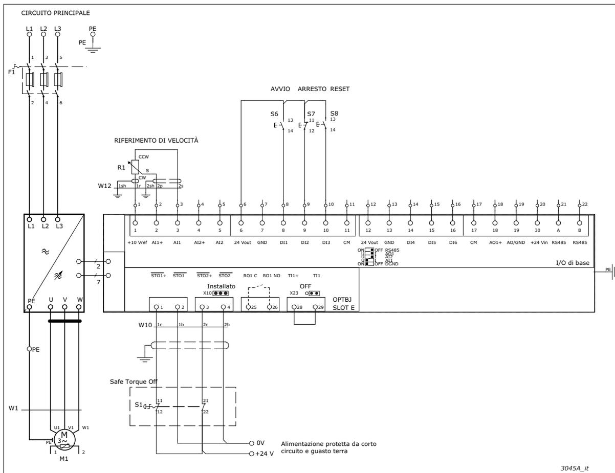
La figura sopra presenta un esempio di connessione della scheda OPTBJ per la funzione di sicurezza STO con reset. L'interruttore S1 è collegato con 4 fili alla scheda OPTBJ, come illustrato sopra. L'ingresso digitale 3 (DIN3), ad esempio, è cablato per la funzione di reset guasti. La funzione di reset (che non fa parte di alcuna funzione di sicurezza) può essere programmata per uno qualunque degli ingressi digitali disponibili.
