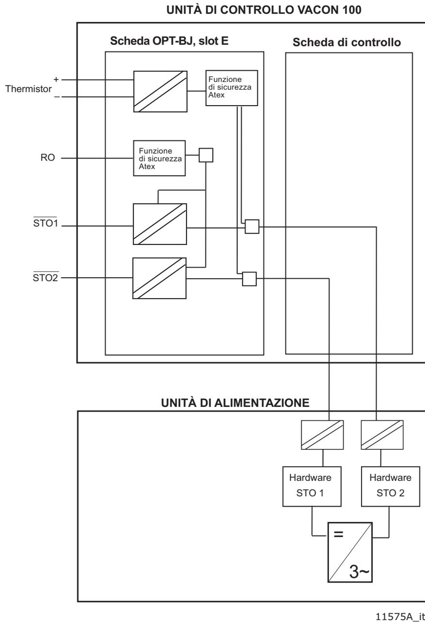
Figura 4. Principio STO con scheda OPTBJ e scheda di controllo di Vacon 100, MR4-10
