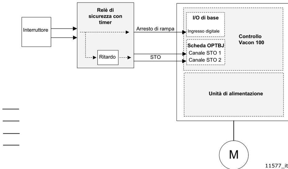
Figura 8. Il principio di collegamento Safe Stop 1 (SS1)
