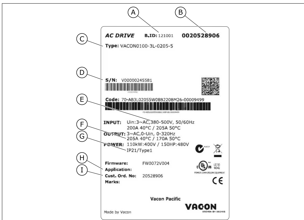
Fig. 1: Étiquette d'emballage des convertisseurs de fréquence Vacon
