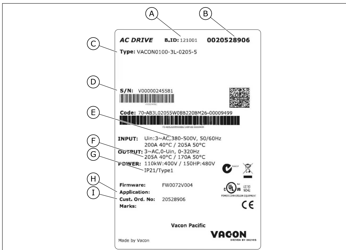
Obr. 1: Štítek na balení frekvenčních měničů Vacon
