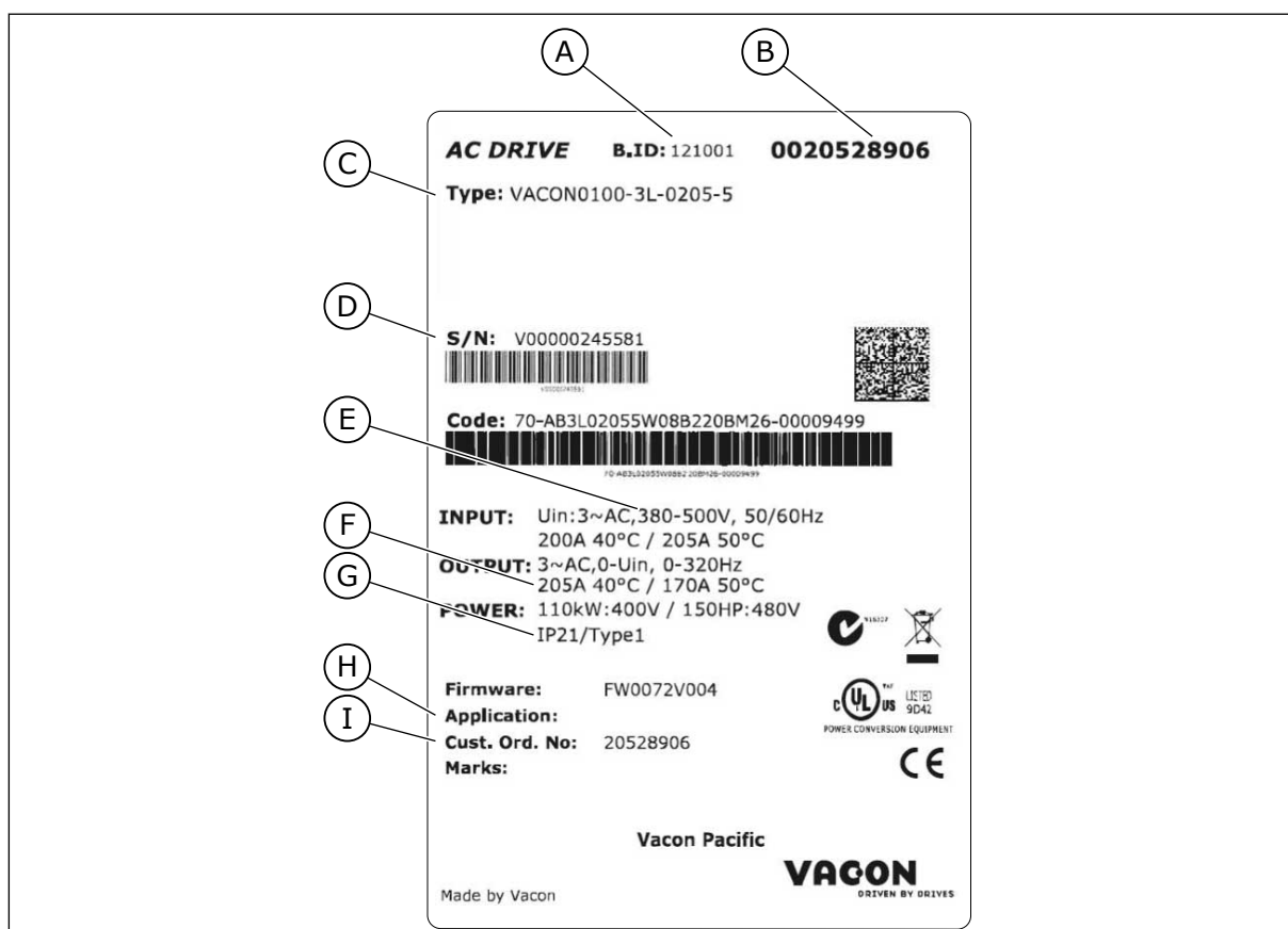
Obr. 1: Štítok na balení frekvenčných meničov Vacon
