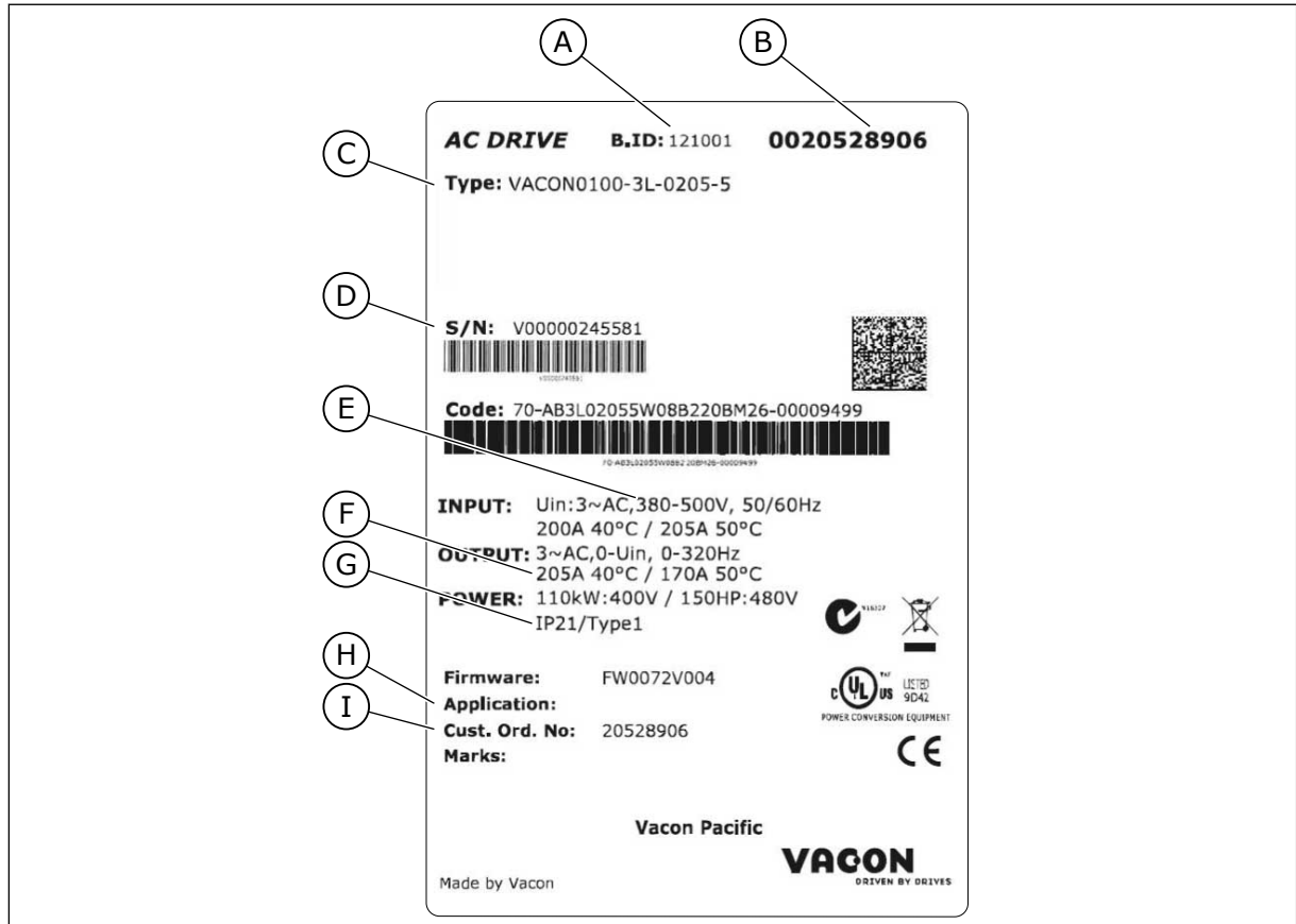
Şekil 1: Vacon AC sürücülerin paket etiketi
