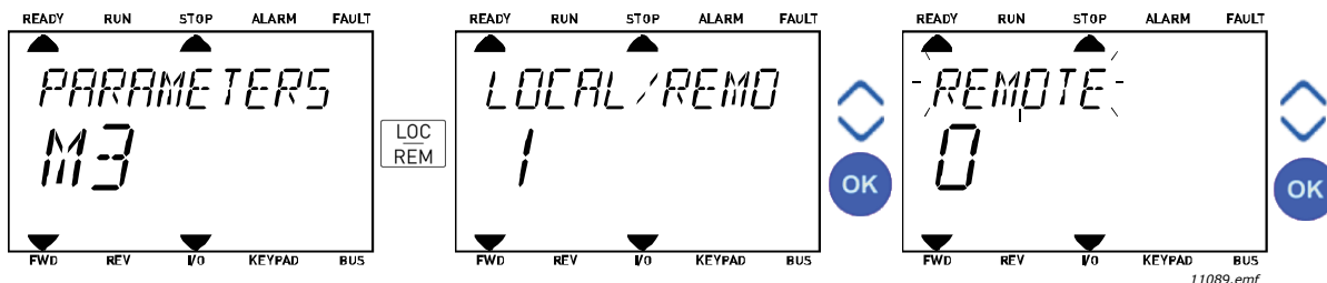
Figura 10. Cambio de los lugares de control
