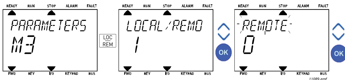
Figura 10. Modifica postazione di controllo
