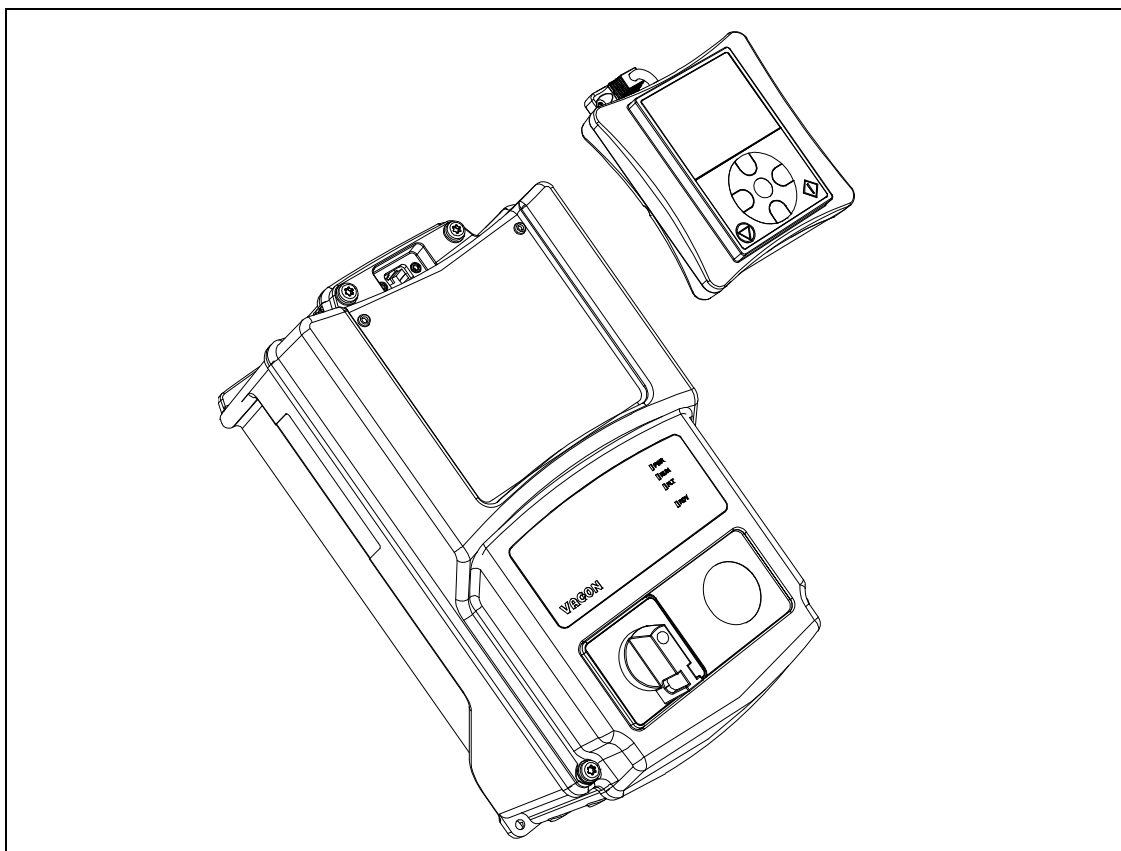
Abbildung 49. Montage der Steuertafel.
