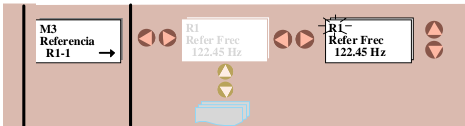
Figura 7-8. Ajuste de la referencia en el panel de control
