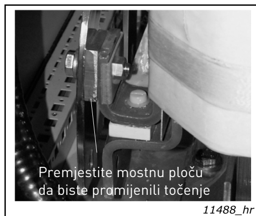
Slika 7. Otcjep ulaznih prigušnica u jedinicama FR13/14
