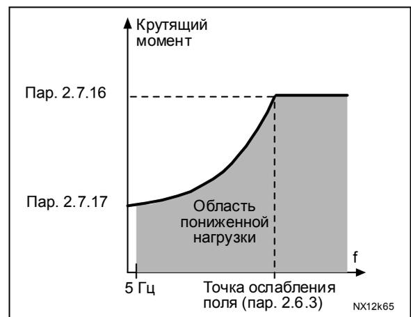
Рис. 1-22. Настройка минимальной нагрузки
