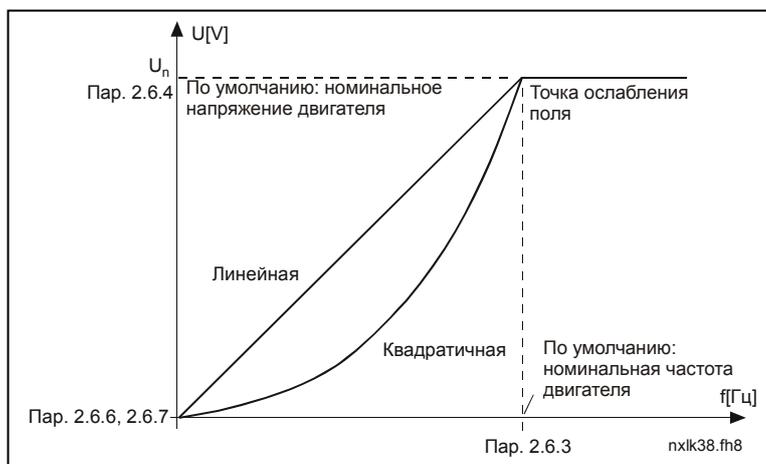
Рис. 1-16. Линейное и квадратичное изменение напряжения двигателя
