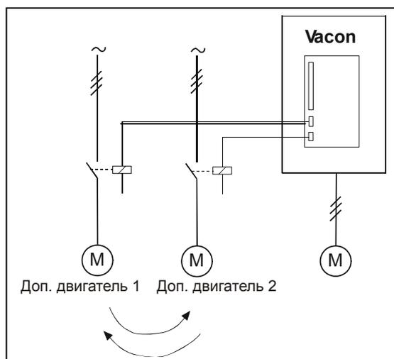
Рис. 1-35. Автозамена относится только к дополнительным приводам.
