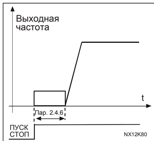
Рис. 1-13. Время торможения постоянным током при пуске
