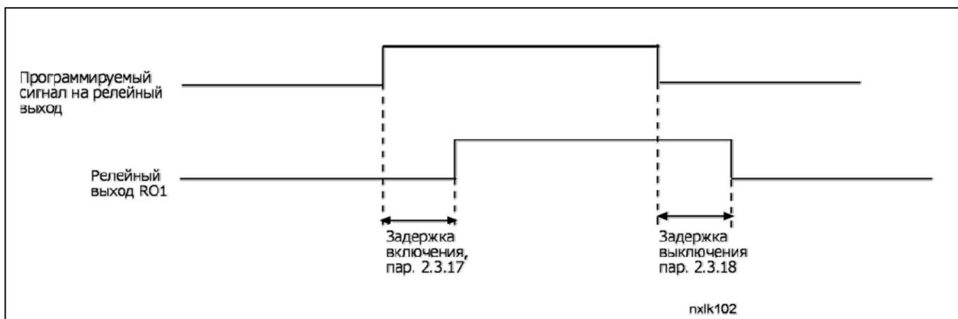
Рис. 1- 9. Задержки включения и выключения выхода реле 1
