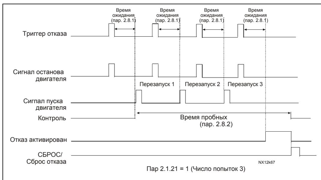
Рис. 1-24. Автоматический перезапуск
