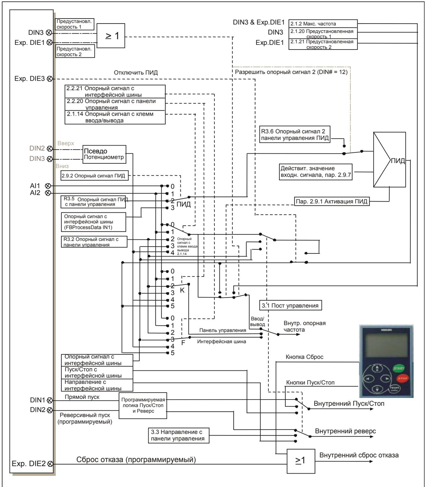
Рис. 1-38. Логика управляющих сигналов программы управления
