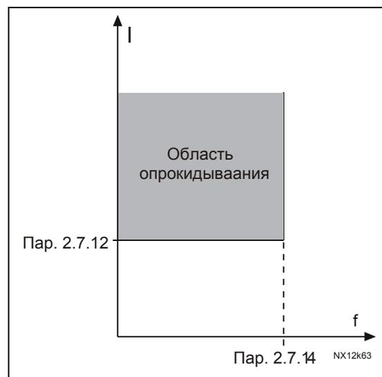
Рис. 1-20. Настройка характеристик блокировки
