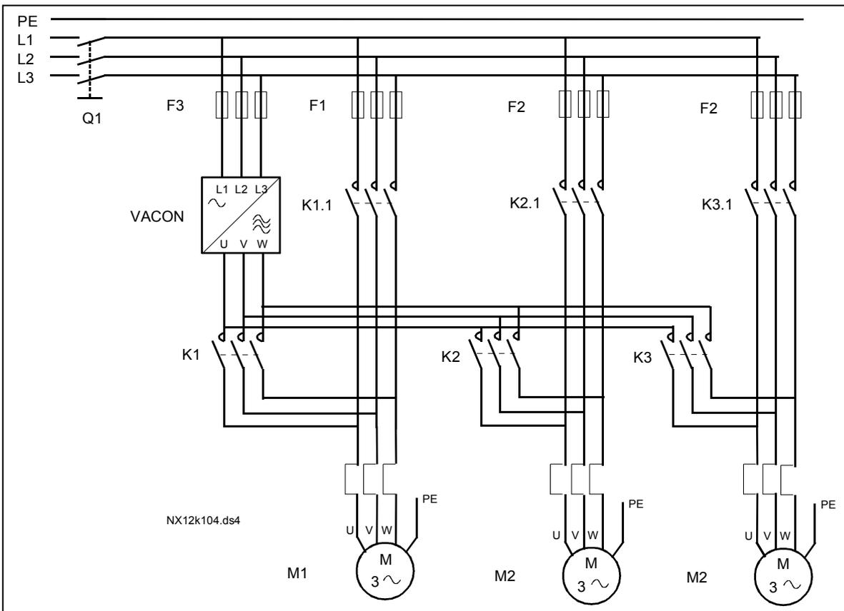
Рис. 1-32. Пример автозамены среди 3 насосов, силовая схема
