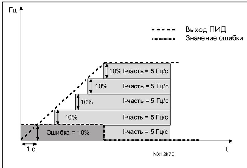
Рис. 1-25. ПИД-регулятор работает как И-контроллер
