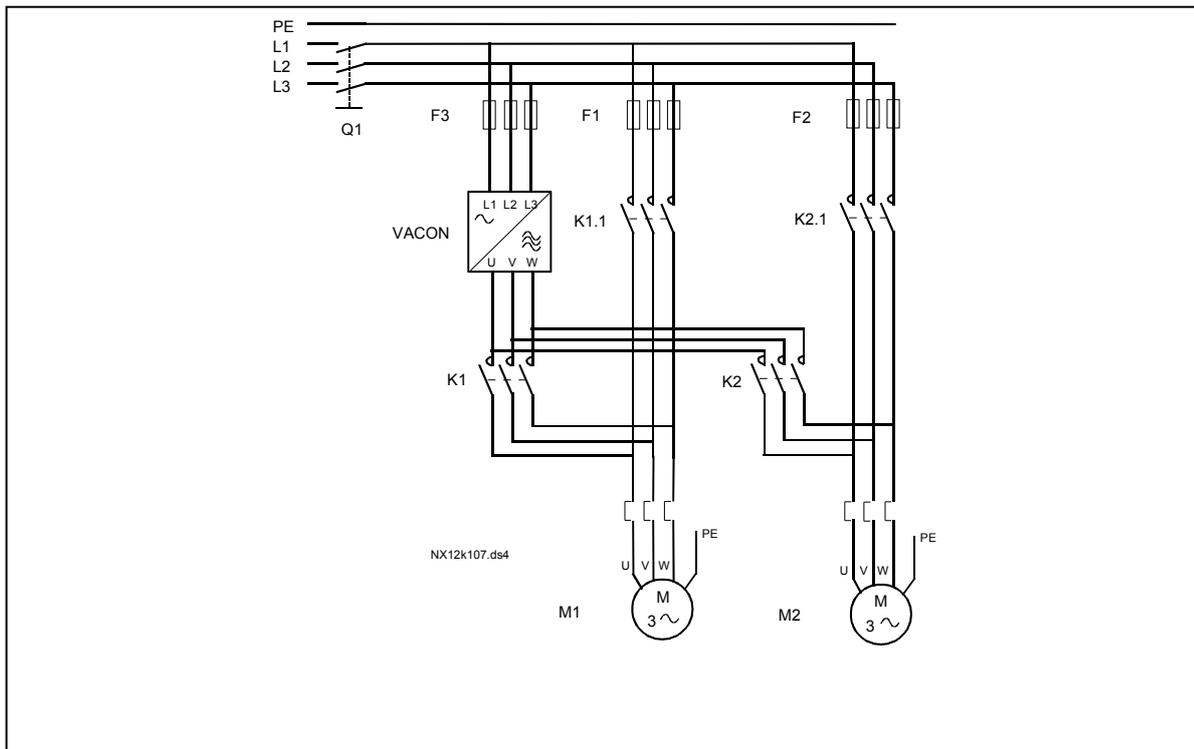
Рис. 1-34. Пример автозамены среди 2 насосов, силовая схема
