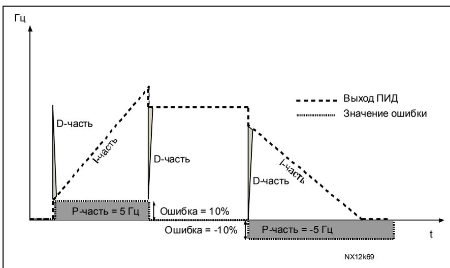
Рис. 1-26. Кривая на выходе ПИД-регулятора в примере 2
