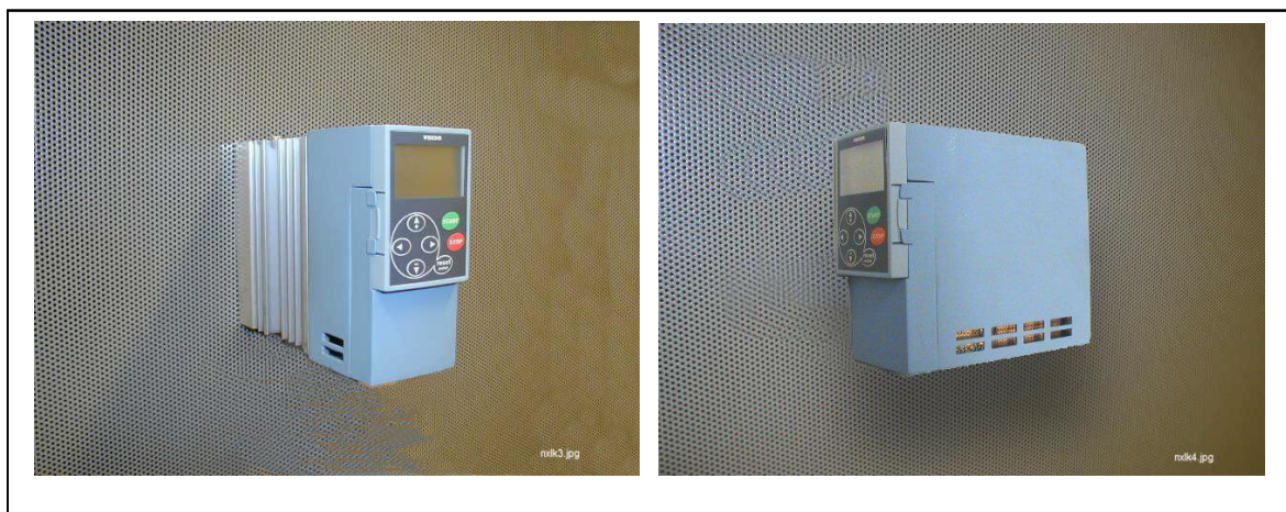
Figura 5-1. Las dos posiciones de montaje posibles de NXL (MF2 y MF3)
