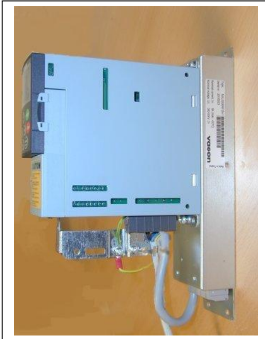
Figura 6-10. MF2 con un filtro RFI-0008-5-1.
