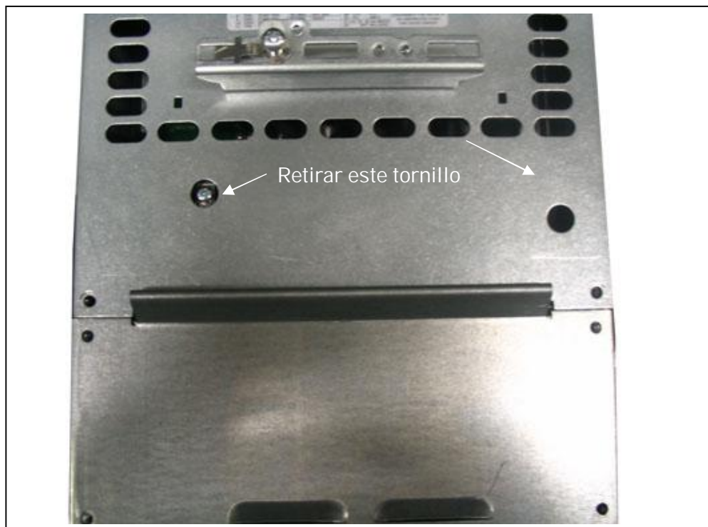
Figura 5-8. Cambio de la clase de protección EMC, MF6
