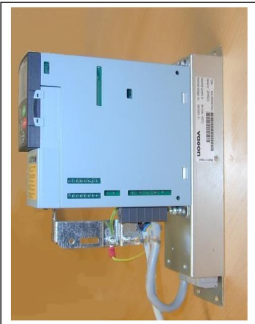
Figura 6-10. MF2 com um filtro RFI, RFI-0008-5-1
