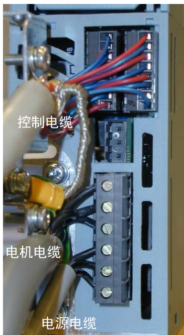
图 6-7. MF2 变频器的电缆安装 (500V, 3~)
