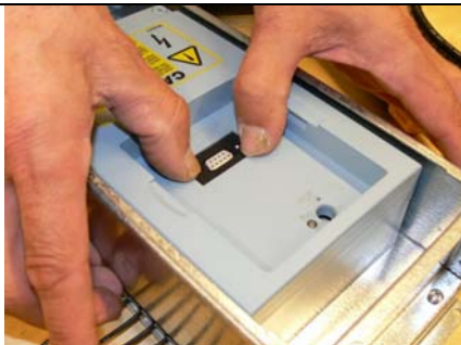
13.将密封条装在 RS485 连接器周围。
