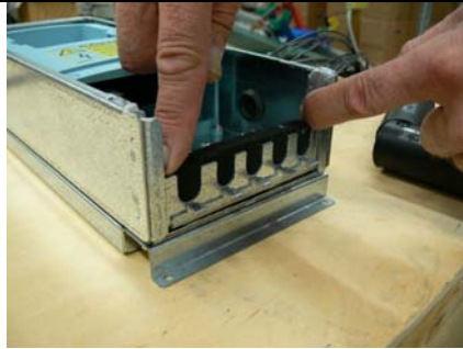
8.将泡沫塑料垫圈按进机壳的滑槽内。
