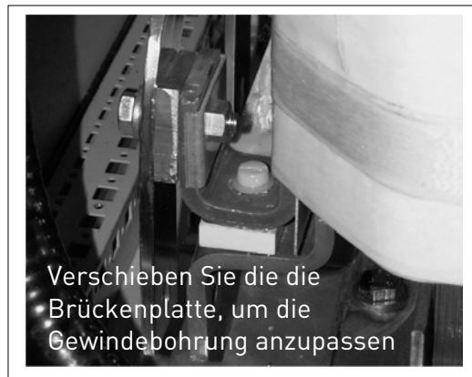
Abbildung 7. Eingangsdrossel-Abgriffe in FR13/14-Einheiten
