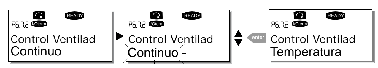
Figura 9-22. Función de control de ventilador
