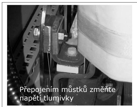
Obr. 5-6. Způsob připojení tlumivek u velikostí FR13/14
