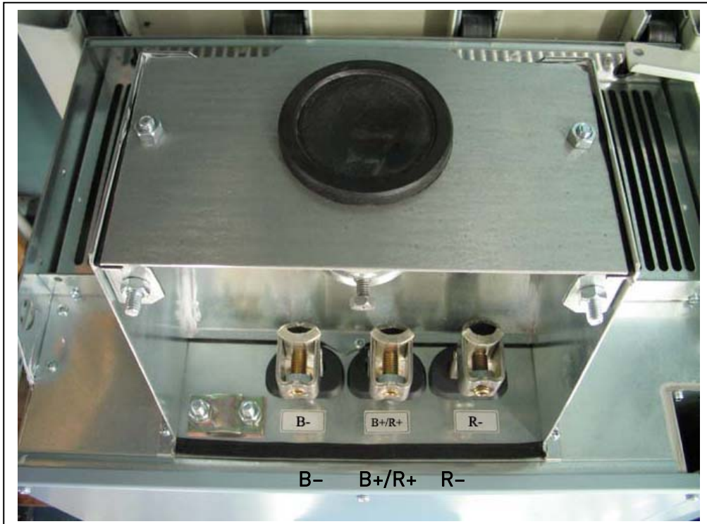
Figuur 6-21. DC-tussenkring en remweerstandsklemmen op Vacon NX FR9; DC klemmen gemarkeerd door B- en B+, remweerstandsklemmen door R- en R+
