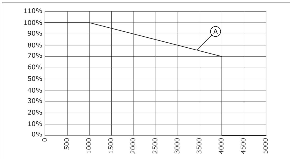
Fig. 18: Capacité de charge à hautes altitudes
