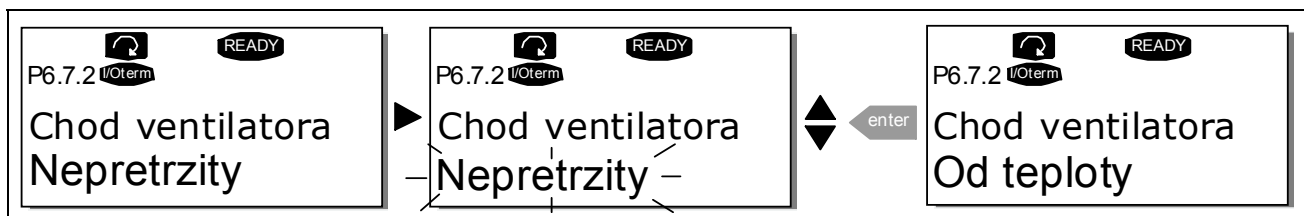
Obr. 7-22. Funkcia riadenia ventilátora
