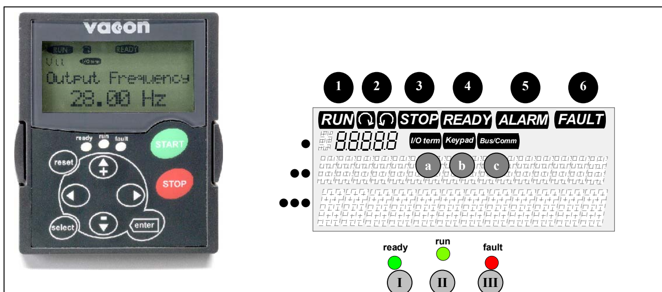
Σχήμα 7-1: Χειριστήριο ελέγχου Vacon και ενδείξεις της κατάστασης της μονάδας.
