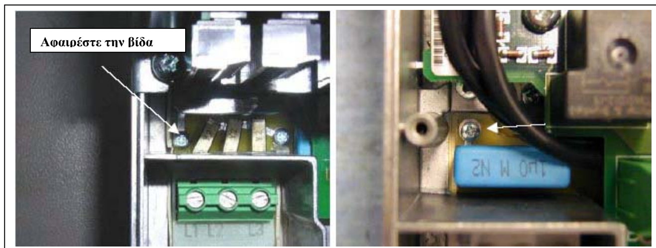
Σχήμα 6-1: Αλλαγή της κατηγορίας προστασίας EMC, FR4 (αριστερά) και FR5 (δεξιά).
