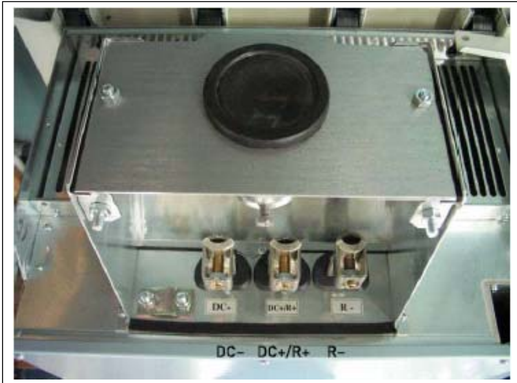
Σχήμα 6-19: Τα τερματικά DC και της αντίστασης φρένου στο FR9, τα DC τερματικά είναι σηματοδομένα με DC-και DC+, τα τερματικά της αντίστασης φρένου είναι σηματοδομένα με R+ και R-
