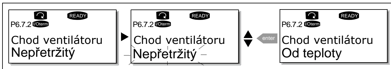
Obr. 7-22. Funkce řízení ventilátoru
