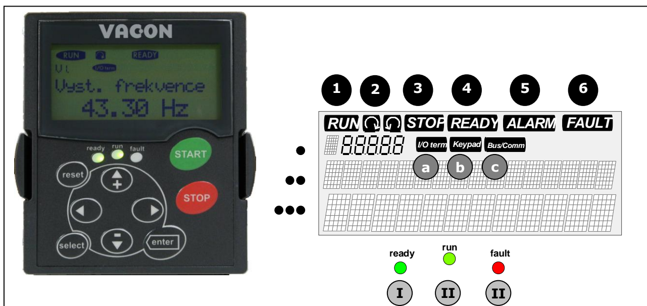
Obr. 7-1. Ovládací panel Vacon a signalizace stavu měniče
