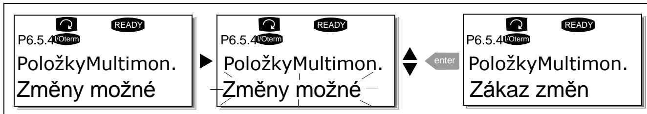
Obr. 7-17. Povolení změny položek multimonitorování
