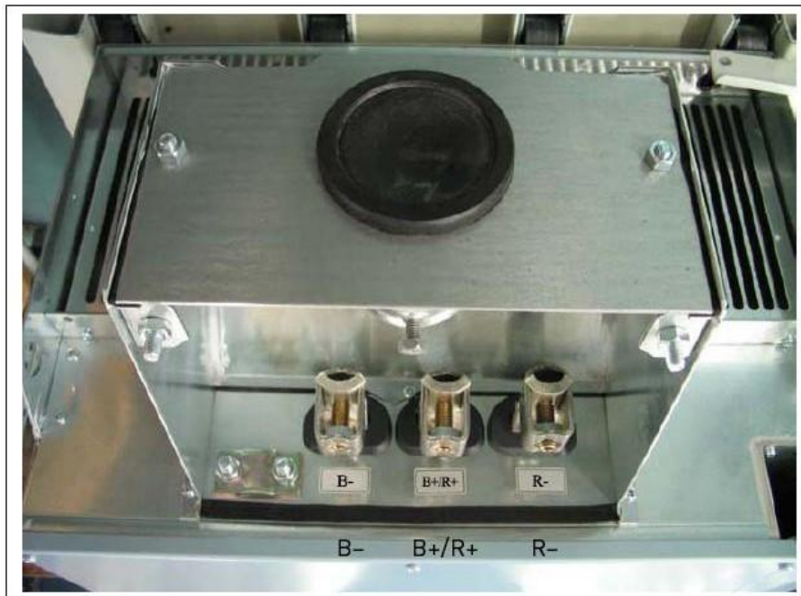
Obr. 6-21. Svorky s.s. meziobvodu a brzdného rezistoru pro FR9; Svorky s.s. meziobvodu jsou označeny B- a B+, svorky brzdného rezistoru jsou označeny R+ a R-
