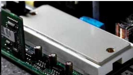
Geïntegreerde koeling voor de IGBT's
