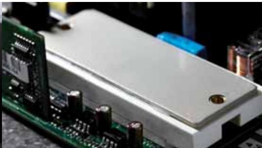
Интегрирано в IGBT устройство за контрол на температурата.
