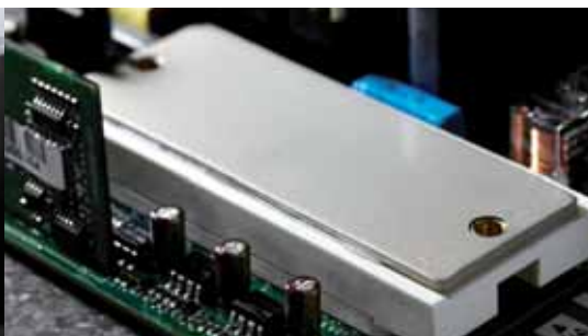
Control al căldurii integrat în tranzistorul IGBT
