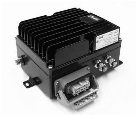
Bild einer DMS-Einheit mit Profibus-Karte, mit 4 x M12 Stecker für Sensoren und Harting-Stecker für Motoranschlüsse.
