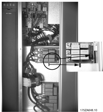
Compact IP20 og NEMA 1 VLT 6052 - 6122 380 - 460 V VLT 6027 - 6032 200 - 240 V VLT 6052 - 6072 525 - 600 V
