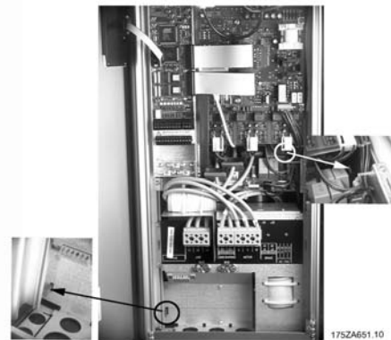
Krytí IP 54, provedení kompaktní VLT 6016 - 6032 380 - 460 V VLT 6006 - 6011 200 - 240 V
