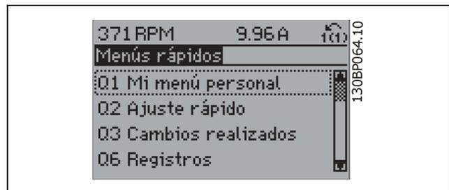
Seleccione *Configuración rápida* para ajustar una cantidad limitada de parámetros y conseguir que el motor funcione óptimamente. El ajuste por defecto de los demás parámetros toman en cuenta las funciones de control deseadas, además de la configuración de las señales de entrada/salida (terminales de control).
