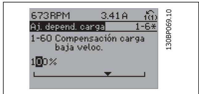
Utilice las teclas de navegación arriba/abajo para modificar el valor de dato. La tecla arriba aumenta el valor de dato y la tecla abajo, lo reduce. Coloque el cursor sobre el valor que desea guardar y pulse [OK] (Aceptar).
