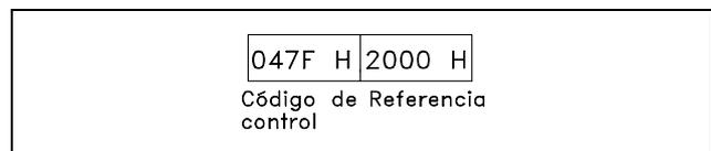
El convertidor de frecuencia debe recibir un comando de arranque y la referencia se debe ajustar en el -50% (-2000 Hex) del rango de referencia.
