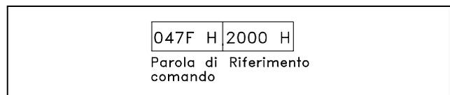
Il convertitore di frequenza riceve un comando di avviamento e il riferimento viene impostato al -50% (-2000 Hex) dell'intervallo di riferimento.
