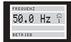
Zeile 2 zeigt den Datenwert einer Betriebsvariablen mit der dazugehörigen Einheit, und in Zeile 1 erscheint eine Erklärung zu Zeile 2. Im Beispiel wurde *Frequenz* als Anzeige über Parameter 009 *Große Displayanzeige* gewählt. Im Normalbetrieb kann mit den [+ / -] Tasten direkt eine neue Betriebsvariable eingegeben werden.
