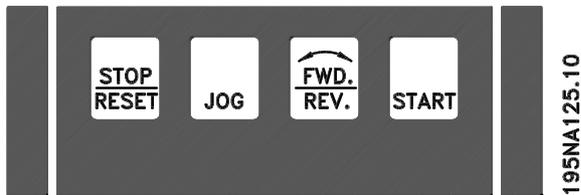
**[STOP/RESET]** dient zum Anhalten des angeschlossenen Motors oder zum Quittieren (Reset) des Frequenzumrichters nach einer Störung. Kann über Parameter 014 *Ort Festdrehzahl* aktiv oder inaktiv gewählt werden. Ist die Stoppfunktion aktiviert, so blinkt Displayzeile 2.
