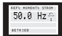
Hier werden die Parameternamen und Einheiten der Betriebsvariablen in der ersten und zweiten Zeile angezeigt. Zeile 2 der Anzeige bleibt unverändert.
