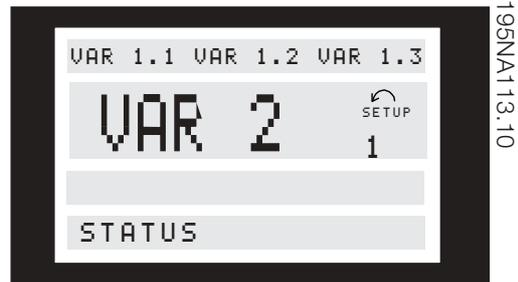
Im Normalbetrieb können nach Wahl dauernd bis zu vier verschiedene Betriebsvariablen angezeigt werden: 1,1 und 1,2 und 1,3 und 2. Der aktuelle Betriebszustand bzw. Alarm- und Warnzustände werden in Zeile 2 numerisch angezeigt.
