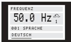
In der untersten Zeile des Displays wird der Wert angezeigt, der bei Quittierung mit [OK] eingelesen (gespeichert) wird.
